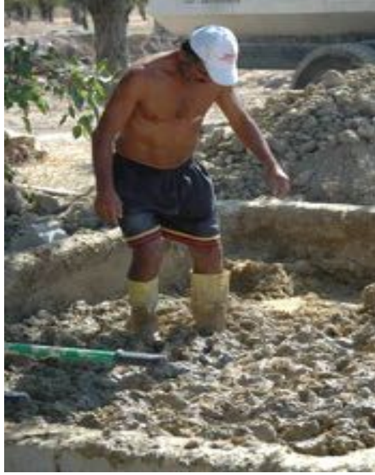
Şekil 6. Geleneksel kerpiç üretimi: toprak+su+saman karıştırma havuzu
